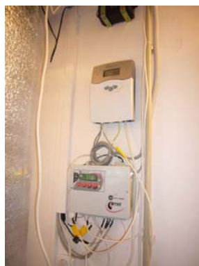
Obr.11 Měřicí ústředny MS Data logger a Delta Sol Regulus
