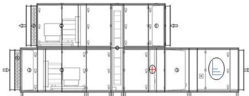
Obr. 3 Uspořádání jednotky s ROV a parním vlhčením
