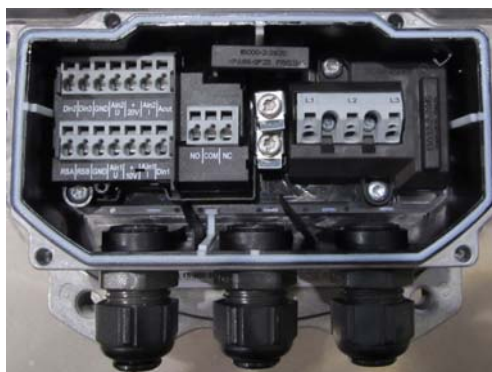
Obr. 2 Detail svorkovnice motoru M3G150. V pravé části můžete vidět napájecí svorky, v prostřední části zemní svorky a výstupy relé, v levé části pak svorky řízení motoru. Vše v provedení WAGO pro snadnou montáž.
