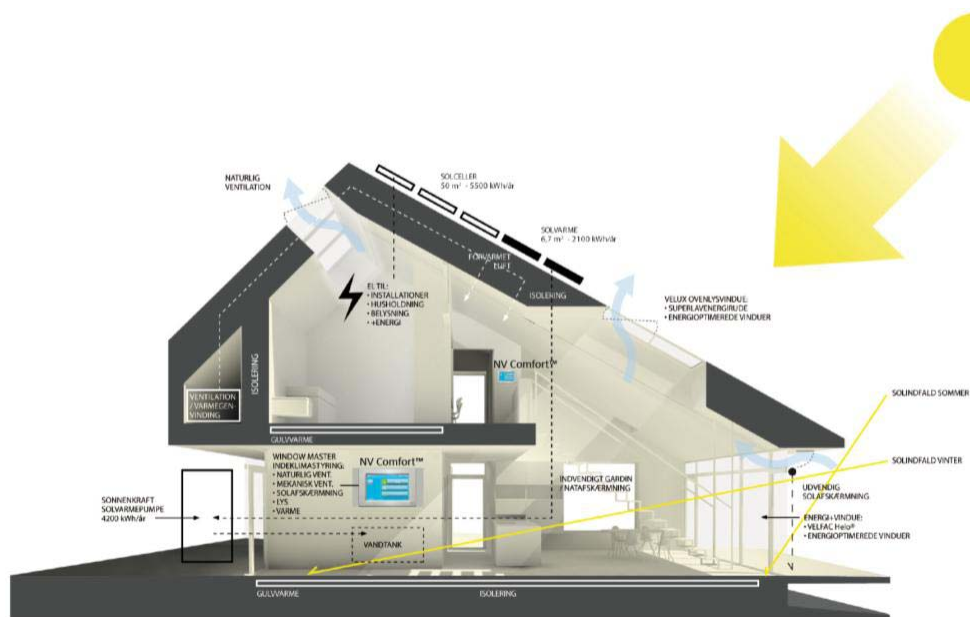
Obr. 5 Principy přirozeného větrání v "Home For Life" (VKR 2010)
