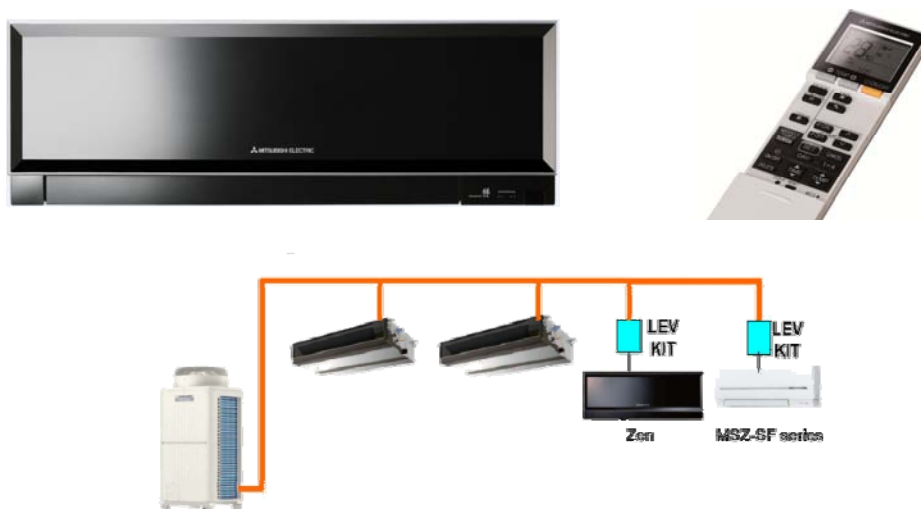
Obr. 1 Nové designové jednotky MSZ-EF a jejich připojení na VRF systém City Multi
