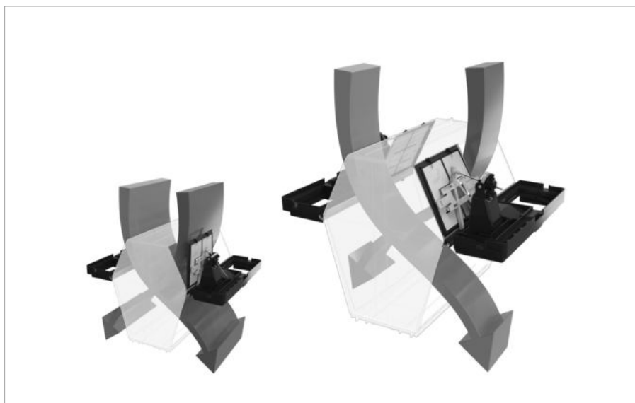
Modulační bypass – velká technologická výhoda řešení Zehnder – nastavuje „inteligentním“ způsobem úroveň zpětného získávání tepla a chladu.
