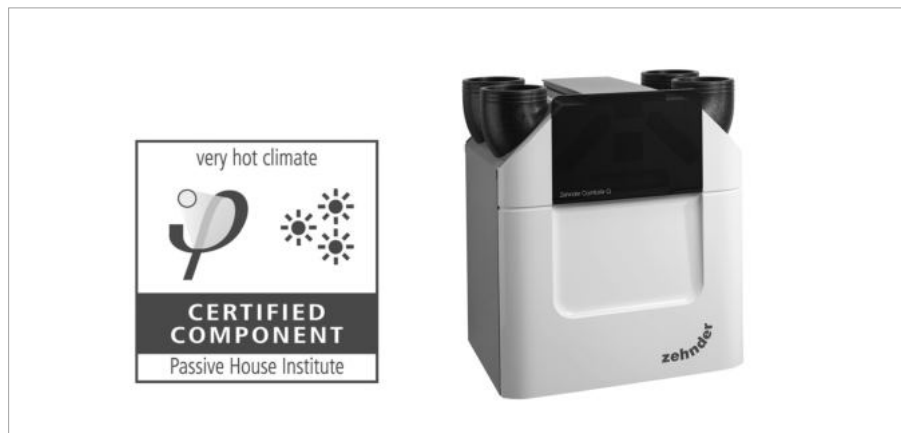
Větrací jednotka Zehnder ComfoAir Q s certifikací Passive House pro teplá podnebí. Díky vysoké účinnosti zpětného získávání chladu a efektivnímu modulačnímu bypassu pro ventilační chlazení poskytuje vysoký komfort větrání také za horkých letních dnů.
