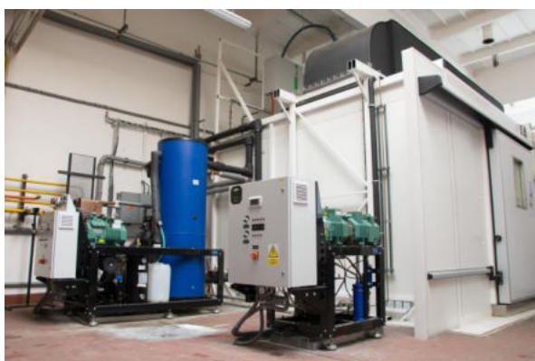
Obr. 1 Klimatická komora pro zkoušky tepelných čerpadel vzduch/voda (vlevo) // Měřicí a regulační smyčka MAR 01 (vpravo). [7]
