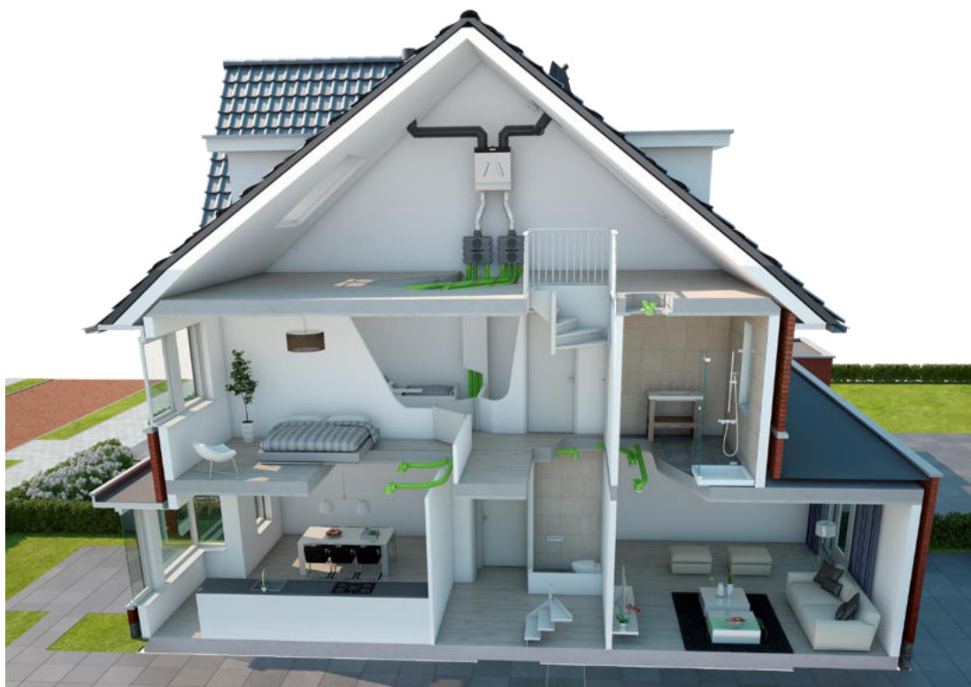
Obr. 1 Hvězdicovité zapojení vzduchovodů v rodinném domě
