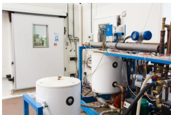
Obr. 1 Klimatická komora pro zkoušky tepelných čerpadel vzduch/voda (vlevo) // Měřicí a regulační smyčka MAR 01 (vpravo). [7]
