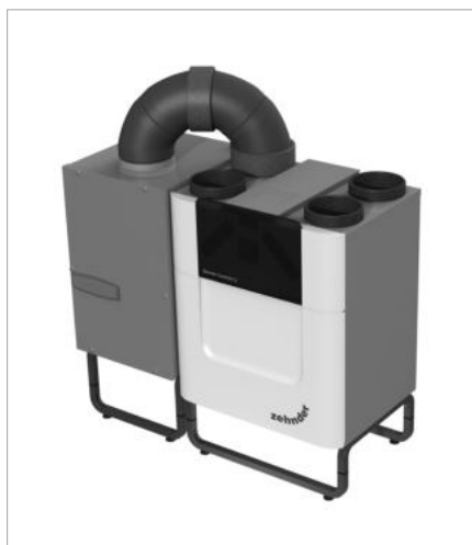
Solankový zemní výměník tepla Zehnder ComfoFond-L Q využívá obnovitelné energie ze země pro ochlazování přiváděného venkovního vzduchu v létě a jeho předehřev v zimním období.
