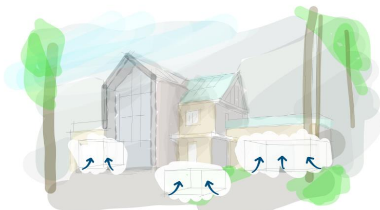
Obr. 2 Pronikání radonu do vnitřního prostoru
