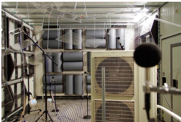
Obr. 3 Pohled do komory s akustickými úpravami pro měření akustického výkonu
