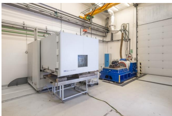
Obr. 3 Elektromagnetický vibrační stůl s klimatickou komorou
