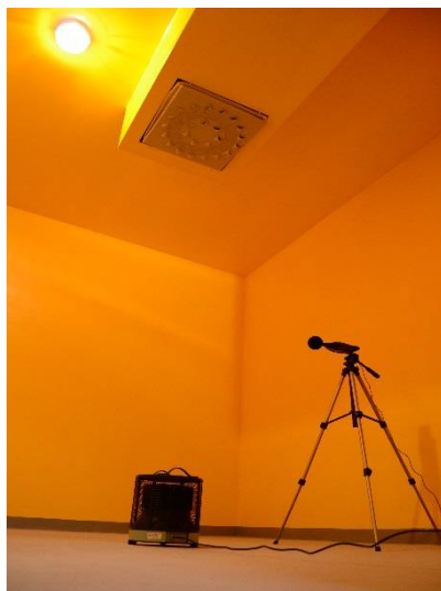
Obr. 6 Měření tkaninové vířivé vyústky SquAireTex
