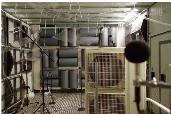
Obr. 6 Měření akustických parametrů tepelného čerpadla v dozvukové komoře
