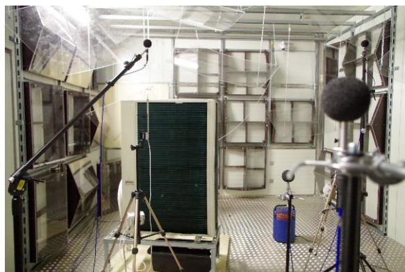
Obr. 6 Měření akustických parametrů tepelného čerpadla v dozvukové komoře
