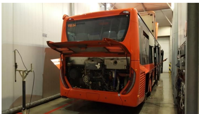
Obr. 1 Klimatická zkouška autobusu
