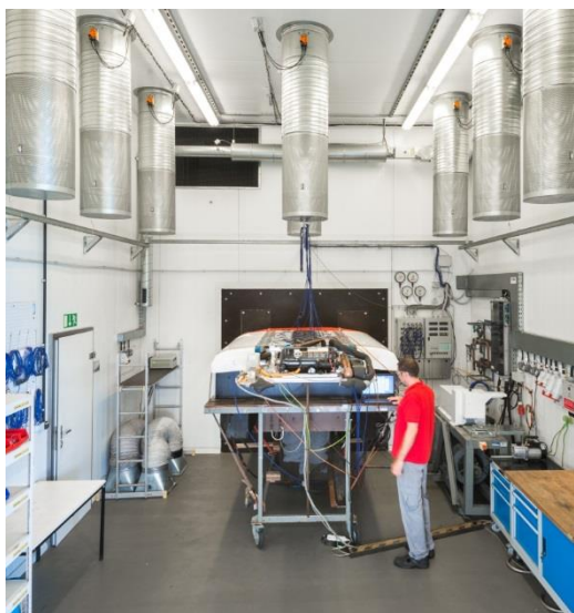
Obr. 5 Měření chladicího a topného výkonu chladicí jednotky
